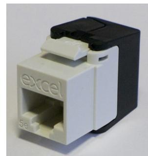
Suite au succès des noyaux Excel version courte de catégorie 6A, nous présentons désormais deux nouvelles versions courtes pour les catégories 5e et 6. Ces noyaux sont tous deux non blindés, de taille réduite et sans outil. Ces nouveaux noyaux ont été conçus pour réduire la profondeur nécessaire des boîtiers s'ils sont utilisés dans les prises. Ces nouveaux noyaux haute performance sont disponibles en blanc et en noir.
