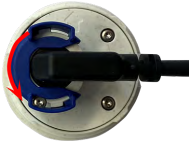
Fig. 22: Unock sensor module
